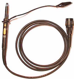
Sonde et zoom du sélecteur (à mettre sur x1)
