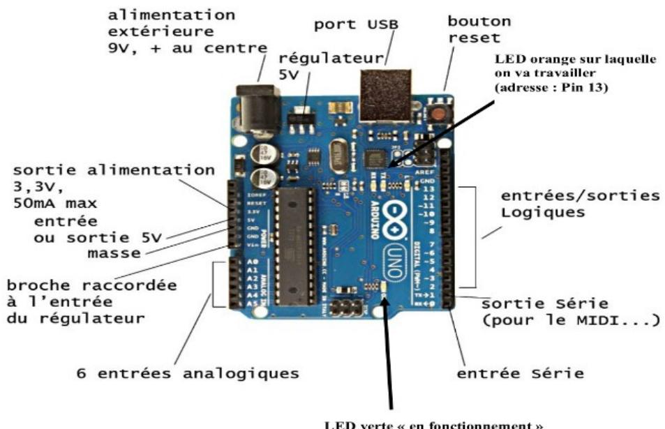
Il possède donc des entrées / sorties logiques (« digital » en anglais), des entrées analogiques (0 à 5V), des moyens de communication série et bien sûr un résonateur à quartz d'une fréquence de 16MHz.
